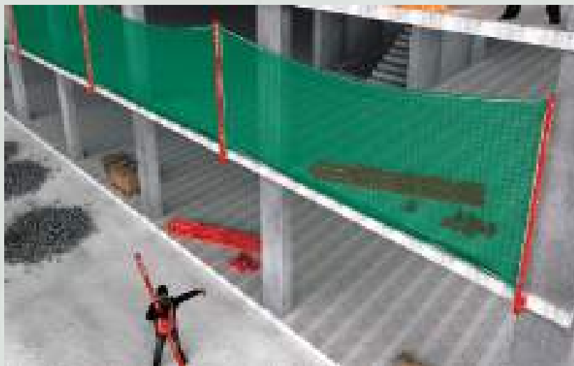
Moduł LiteMESH w konfiguracji mocowania czołowego.
