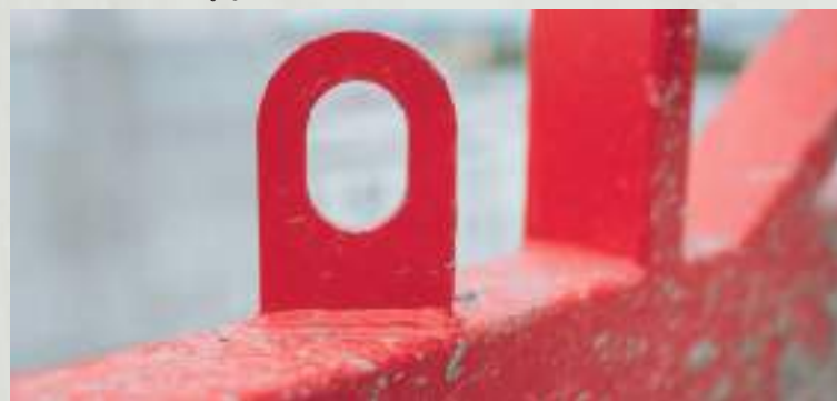
Mocowanie zawiesia dźwigu.
