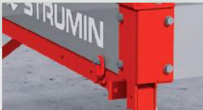
Blokada transportowa nóg uchylnych.
